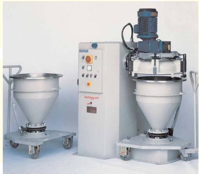
**1 MRV 600** - Mélangeur à cuve basculante avec hélice à 130 tours par minute. Moteur de 18,5 kW.
