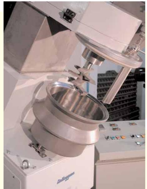
**1 MPV 20/S** - Mélangeur à cuve tournante de laboratoire de 20 litres de capacité totale.
