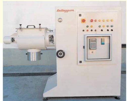
**1 ME 20000** - Mélangeur en acier inoxydable monté sur pesons. Conception antidéflagrante. Puissance 90 kW.
