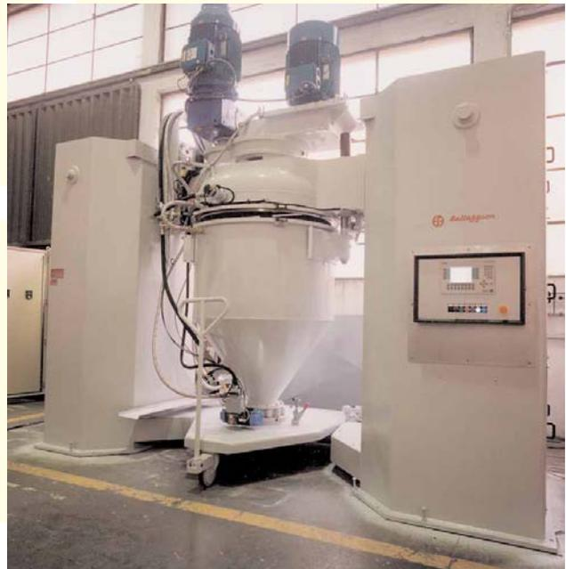
**3 MCRP 2000** - Mélangeur à vis planétaire de 0,7 à 2 tours par minute. Vitesse de rotation de la vis de 20 à 60 tours par minute.
