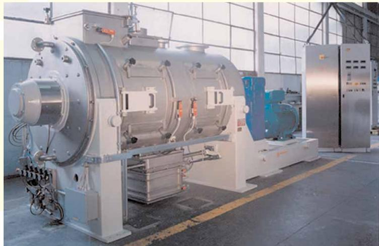
**1 MVO 600** - Mélangeur à socs construit en acier inoxydable selon les standards ASME.
