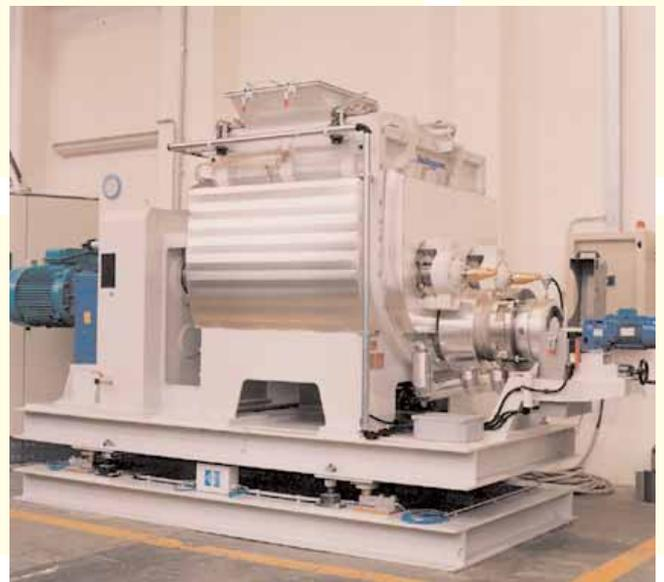
**2 IPC 10 AP/T** – Malaxeur extrudeur de 10 litres muni d'un moteur de 8,5 kW. L'extrémité de la cuve est totalement ouvrable pour le nettoyage. Application pharmaceutique.
