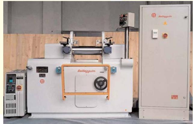
**1 MCC 150X300/E** - Mélangeur bicylindres de laboratoire avec deux rapports 33 : 33 et 33 : 24 tours par minute. Cylindres chauffés électriquement.
