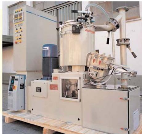
**1 TS 1000/S** - Turbomélangeur haute vitesse spéciale avec partie basse d'usure séparée pour un remplacement facile et économique. Le produit mélangé est vidangé par une vanne située au fond du mélangeur. Le turbomélangeur est utilisé avec une grande efficacité dans la préparation des matériaux de friction.
