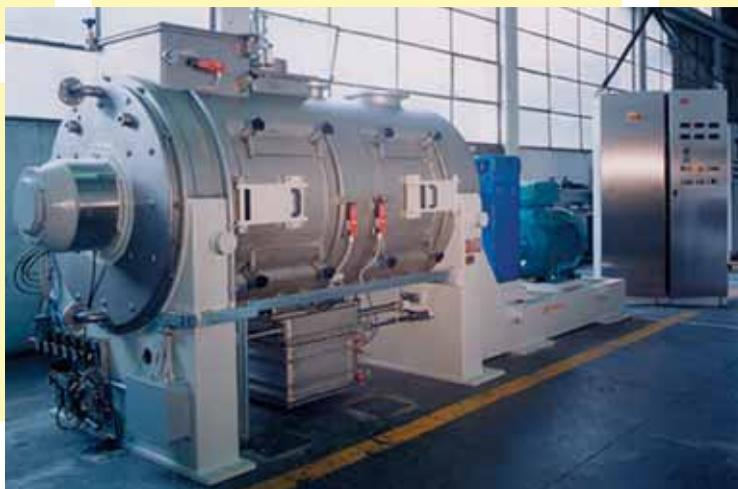
**1 MVO 600** - Modello a vomeri - costruzione secondo norme ASME.
