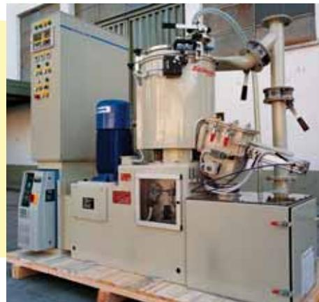
**1 TS 1000/S** - Turbomiscelatori speciali completi di fondo inferiore smontabile, per sostituzione una volta usurato, e valvole di carico prodotti di processo - tipo di applicazione: materiali d'attrito.
