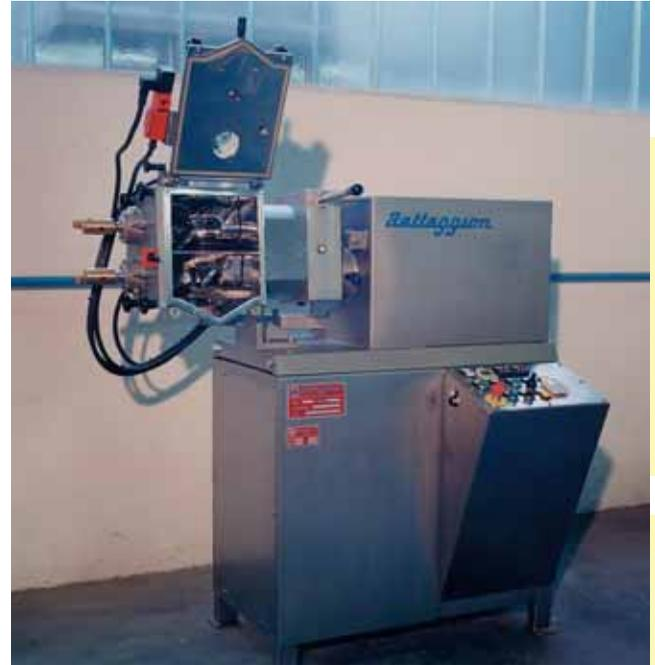
**1 IPI 2000 BP** - Impastatrice ribaltabile in acciaio inox con parti a contatto elettrolucidate e racchiusa da carter di protezione: adatta per applicazioni alimentari.
