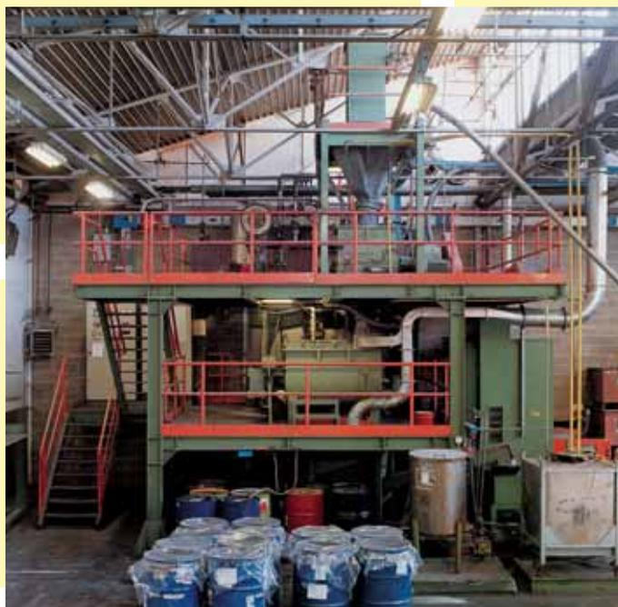
**1 Impianto di turbomiscelazione e di essiccamento sotto vuoto** - vista dei due turbomiscelatori TS 1000/S Turbomixers, e del sistema di carico polveri con filtri posti sopra le macchine di processo.
