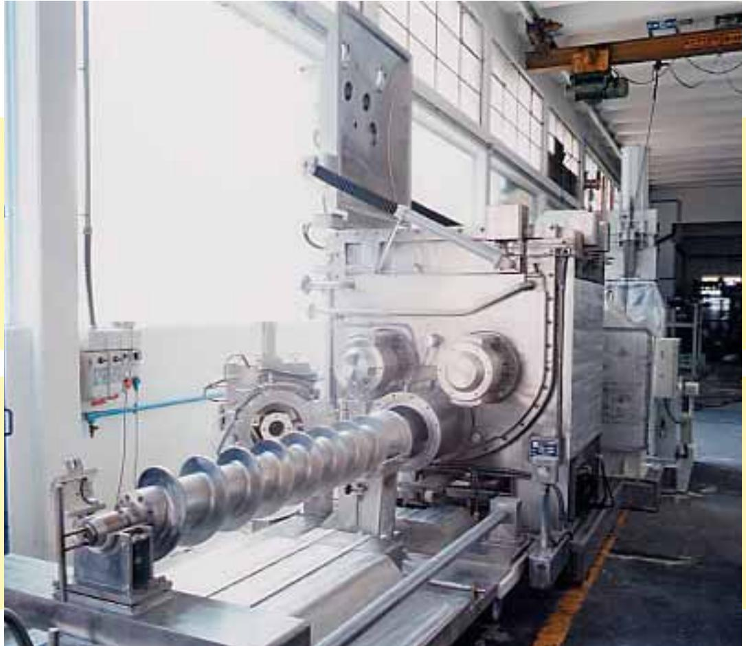
**1 IPC 2500 AP/T-ID** - Impastatrice a sigma con coclea di scarico avente una capacità totale di 2500 litri e totalmente costruita in acciaio inossidabile AISI 316 L o in SAF 2205, adatta a produzioni di prodotti farmaceutici.
