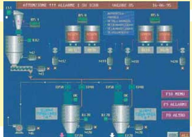
**3 Quadro elettrico di comando e controllo di un Impianto di miscelazione ed essiccamento;** il quadro comprende PLC di gestione e PC contenente tutti i dati riguardanti il processo.
