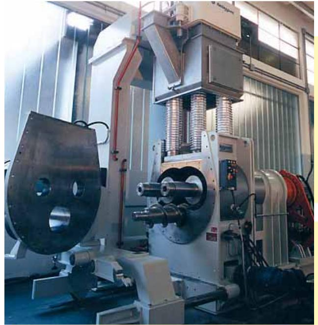
**7/8 IPMC 500 AP/T-HD** - Masticatore con coperchio premente e vite di scarico, avente una capacità totale di 500 litri.
