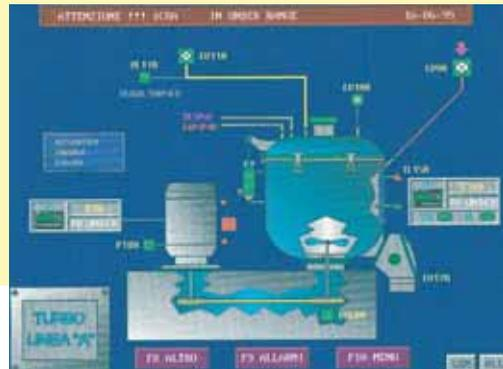
**4 TSOR 1200/3500** - Impianto di Turbomisclazione per compound di PVC rigido - produzione 3000 kg/h - 250 kW sul turbomisclatore / 45 kW sul raffreddatore ad alta efficienza.
