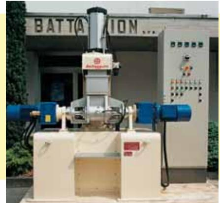
**3 IPMR 500 AP/T-HD** - Masticatore con coperchio premente a vasca ribaltabile su terzo asse, della capacità di 500 litri totali, con comando indipendente degli operatori tramite 2 motori idraulici a bassa velocità da 90 kW l'uno. Vasca, fianchi e coperchio costruiti in acciaio inossidabile AISI 316 L e con camicia; operatori masticatori a due vie con circolazione interna dei liquidi per il condizionamento termico.
